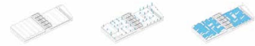
1 Bâtiment existant 2. Poteaux créent patios 3. Toiture vitrée
